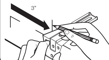
Aligner le haut du boîtier sur les marques qui ont été faites. Centrer sur la fenêtre/porte. Marquer les coins. Mesurer 7,62 cm depuis chaque extrémité et marquer l'emplacement des supports. Placer les supports additionnels à intervalle régulier, si nécessaire. Se reporter au tableau sur l'utilisation des supports à l'étape 1.
